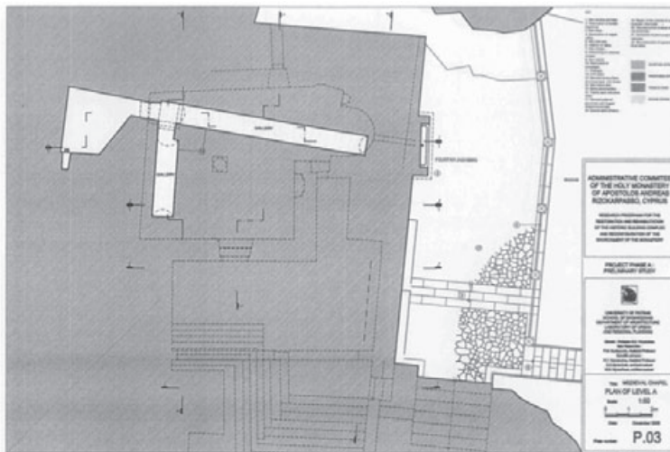
Εικ. 6: Μονή Ἀποστ. Ἀνδρέα, σύστημα αὐλάκων ἀγιάσματος σὲ κάτοψη (σχέδιο Πολυτεχνείου Πατρῶν).
