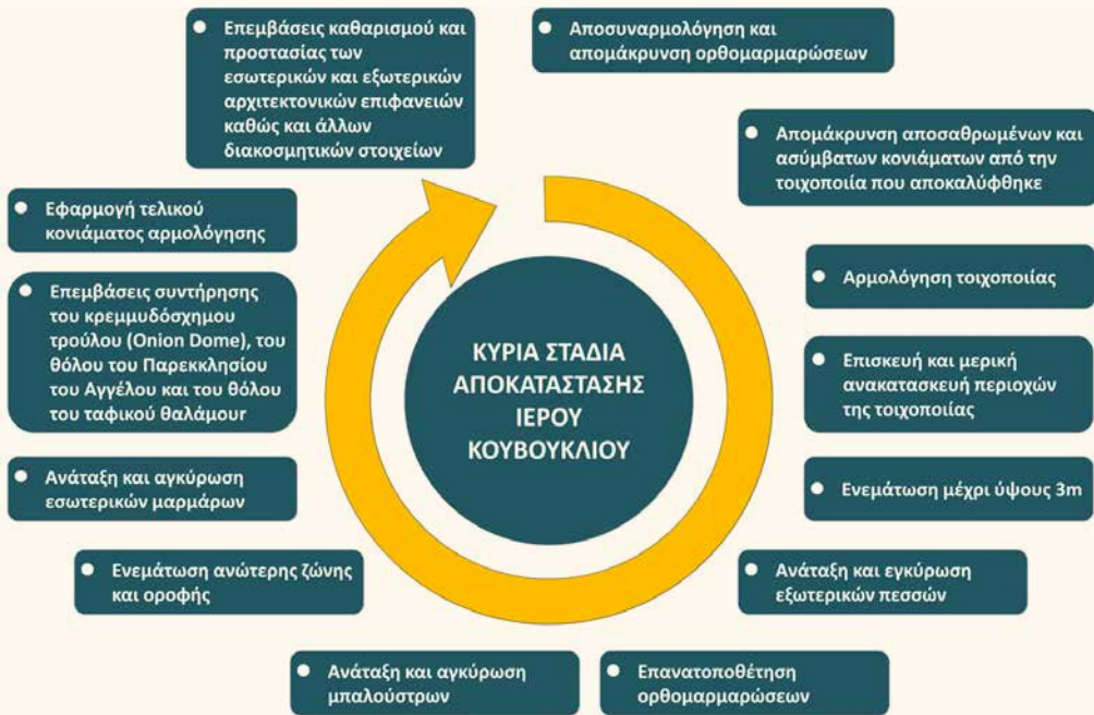
Εικόνα 6. Τα στάδια αποκατάστασης του Ιερού Κουβουκλίου.
