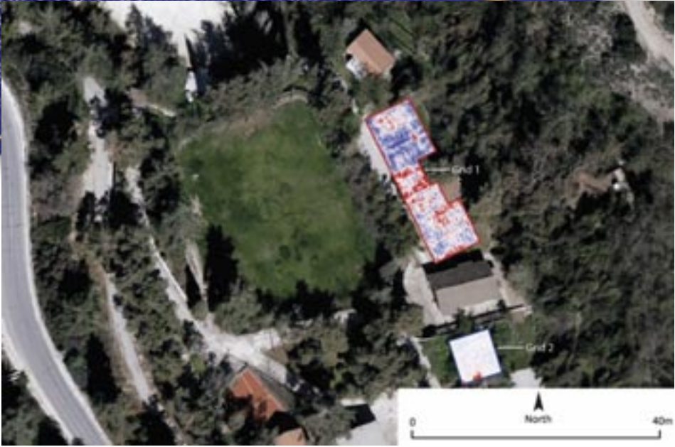
Εικόνα 3. Άγιος Νικόλαος τής Στέγης (οικοδόμημα ανάμεσα στους κάναβους - grids). Grids 1 (βόρεια) and 2 (νότια) με τά δεδομένα από τό GPR (Staffordshire University, The Cyprus Institute).
